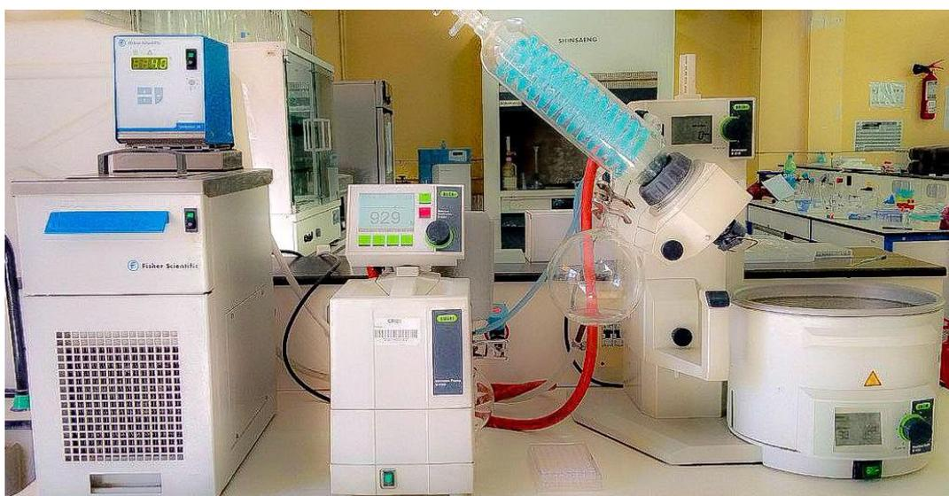
**Figure 13.** Evaporateur rotatif.
