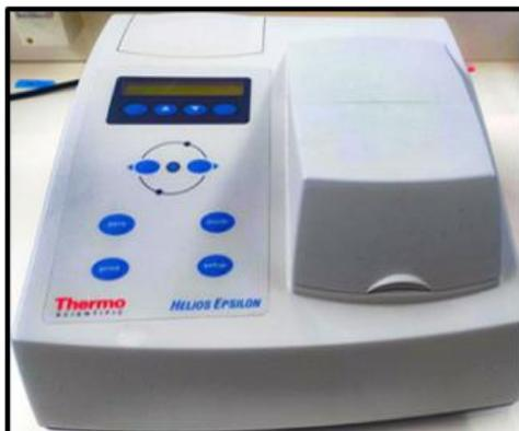
Figure 17. Spectrophotomètre à cuve.
